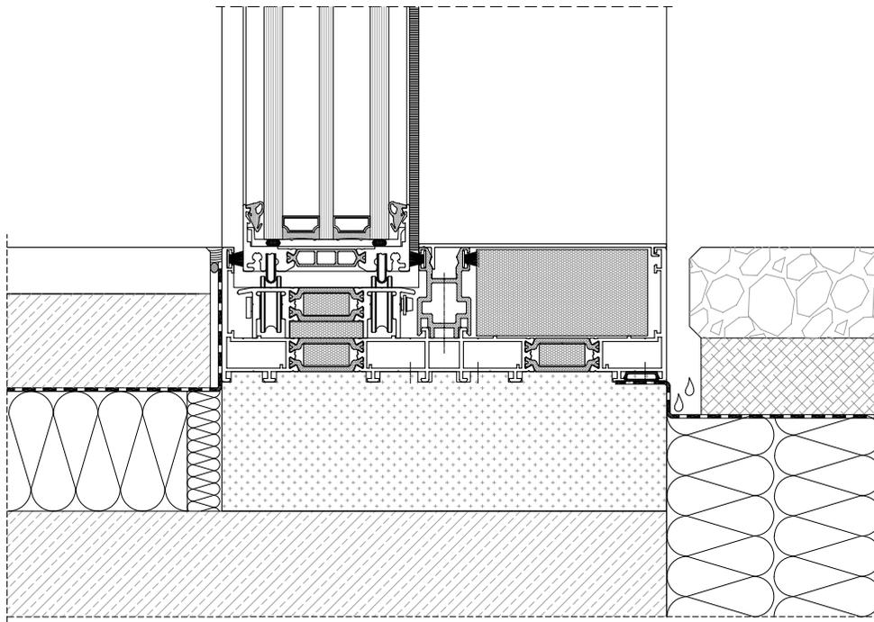
Querschnitt nach dem Falten der Flügel
